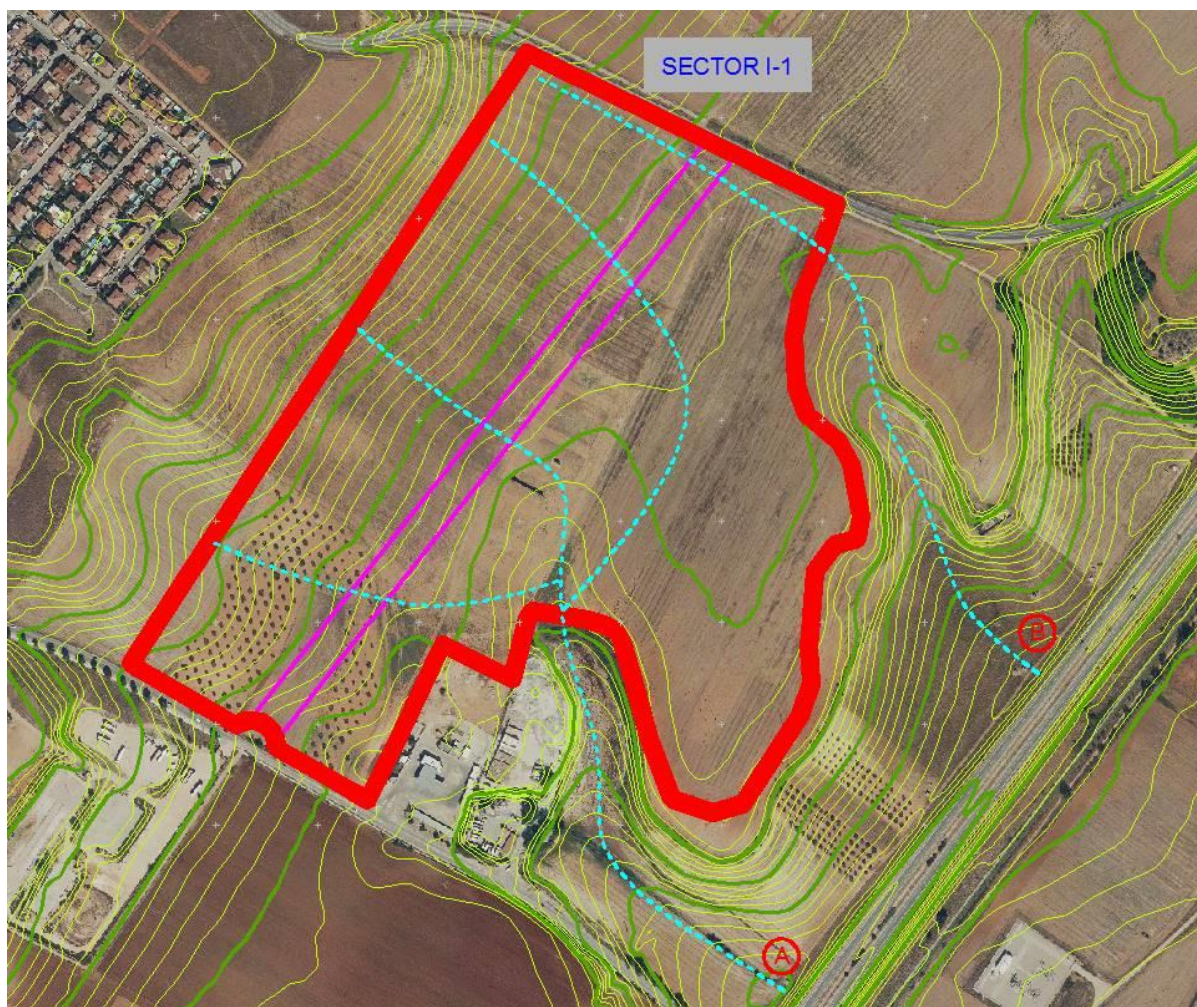
Imagen: Estudio de traza de escorrentía superficial sobre ortofotografía del Sector y curvas de nivel de equidistancia de 1 m. Fuente: IGN y propia
