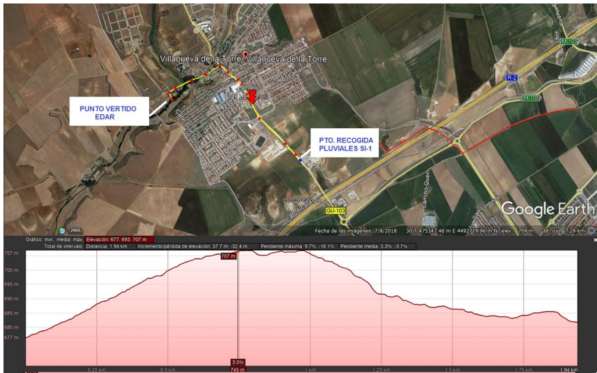
Imagen: Traza de conducción de pluviales a arroyo las Monjas en Meco, traza, longitud y perfil orientativos. Fuente: IGN y Google Earth
